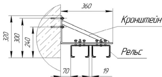
Рельсы с кронштейнами соединяют винты с квадратными подголовниками М10х50. Рельсы должны быть установлены горизонтально в двух плоскостях, от этого зависит лёгкость передвижения полотна в рельсе.
