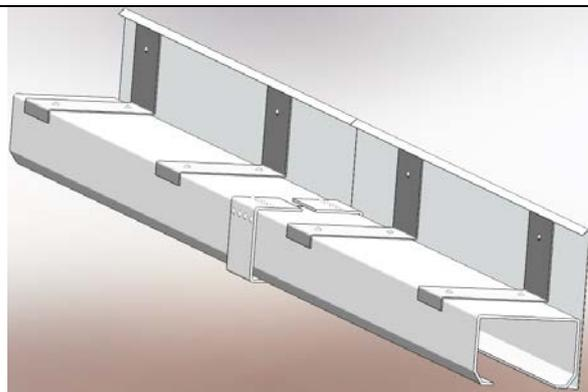
На стыках рельсов декоративная накладка крепится к соединительному элементу рельса.
