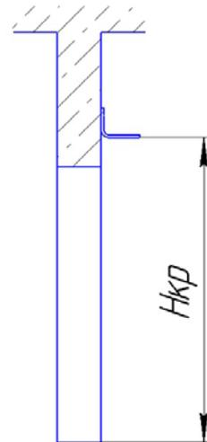
Далее необходимо определить места расположения кронштейнов по горизонту. Расстояние между кронштейнами должно соответствовать расстоянию отверстий в верхней полке рельса (2). Допустимое отклонение составляет  $\pm 5$  мм. Монтаж кронштейнов на проем из кирпича или бетона осуществляется с помощью анкерных болтов М10х80, из металла – сварка.
