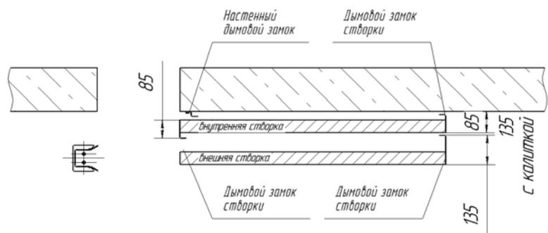
В закрытом состоянии ворот расстояние между дымовыми замками должно быть 10мм.
