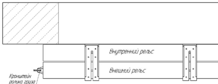
Рельсы устанавливаются вплотную к стене и на расстоянии 19 мм друг от друга, если ворота без калитки или она устанавливается во внешнюю створку.
