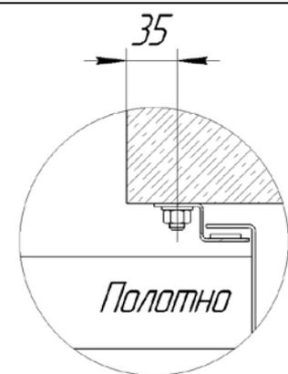
Прикрепите дымовые замки створок (14 и 15) к торцам панелей (кроме первой панели внешней створки) с помощью стальных заклепок 4,0x6 с шагом 400мм.
